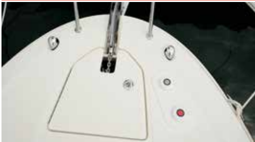
Molinete eléctrico de proa
