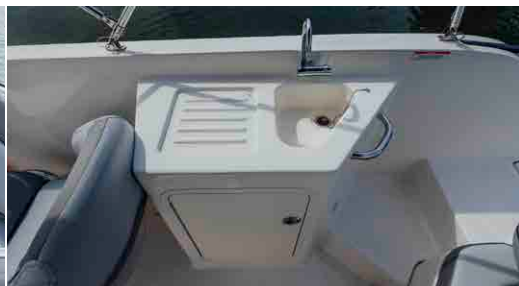
Bartresen mit Frischwasserspüle, Arbeitsfläche und Lebensmittelfach
