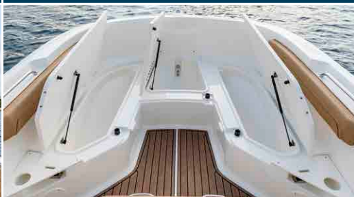
Compartimentos de estiba en proa con resorte de gas
