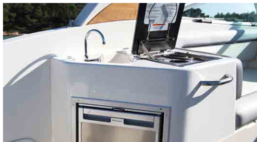
Cuisine de cockpit avec évier, réchaud et réfrigérateur
