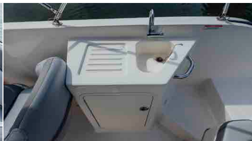
Evier de cockpit avec eau sous pression et rangements
